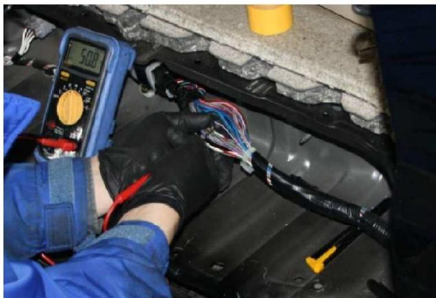
この車輛では右側スライドドア ステップ部分の内装を取り外して接続作業を行います。ステップ部の床内装を取り外すと配線の束があります。この中から
